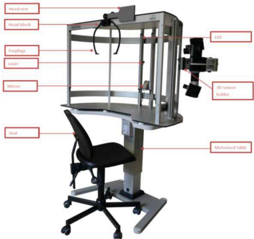
Figura 2. Banco VisioTOP-500. Imagen del banco VisioTOP-500, sobre el que se monta el sensor óptico del AEVA-HE. El voluntario se posiciona en la silla con la espalda pegada al respaldo, ajusta su cara con el espejo y el láser infrarrojo, quedando éste en el medio de los labios. Por último, la posición de su cabeza se ajusta con los tapones para los oídos y el reposacabezas, que el técnico bloquea y desbloquea manualmente cuando el voluntario está en una posición de comodidad.
